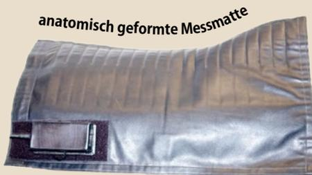
Die objektivierte Druckmessung unter dem Sattel mit der anatomisch geformten medilogic Sattelmatte dient der Kontrolle und Optimierung. Damit bietet das medilogic Messsystem dem Sattler die hervorragende Möglichkeit, seine Arbeit zu kontrollieren und dokumentieren. Der Reiter erhält darüber hinaus ein Feedback über seinen Reitstil.
